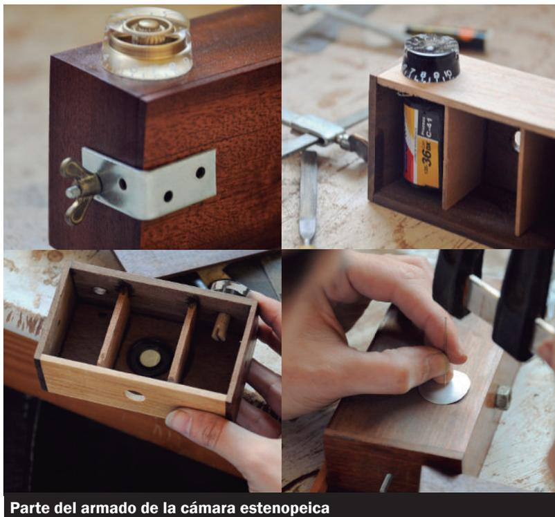
Parte del armado de la cámara estenopeica
